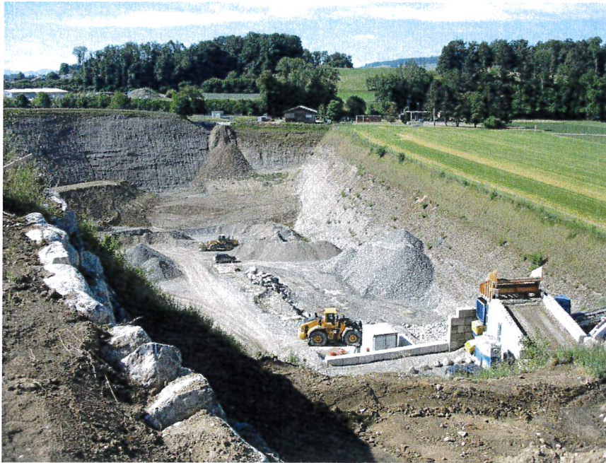
Abbildung 12: Blick am 12. Juni 2020 auf die abgeschlossene 1. Abbauetappe am Stoltenrain . Die Auffüllung und Rekultivierung beginnt, sobald genügend Material dazu vorhanden ist.
